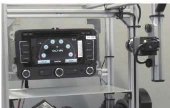
Optisches Inspektionssystem, welches jeden einzelnen Bildschirminhalt der Infotainment-Systeme zur Texterkennung und Verifizierung abfotografiert.
